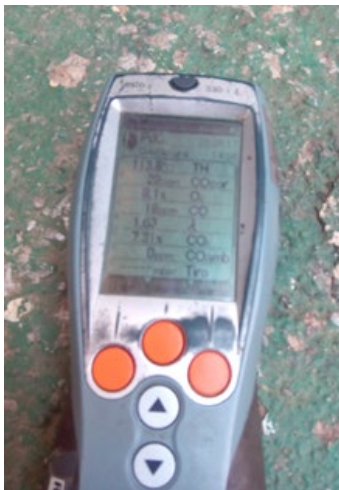
IMG 6. ANALIZZATORE DI COMBUSTIONE
